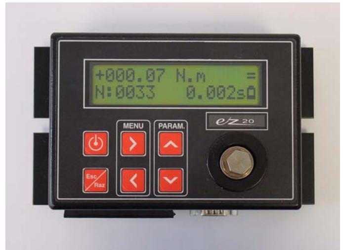
EZ20-Smart Testgerät bis 5 Nm oder 20Nm
