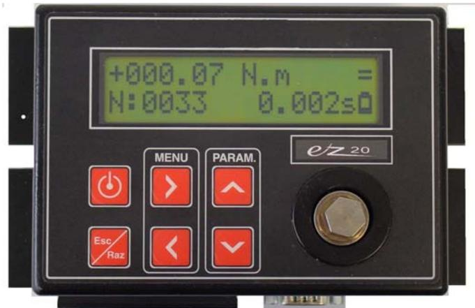
EZ20-Smart Testgerät bis 5 Nm oder 20Nm
