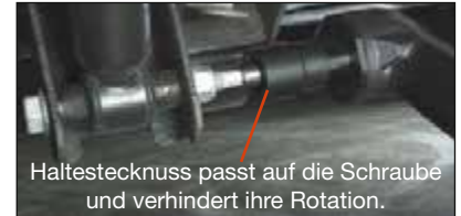
Hold & Drive Werkzeug nähert sich der Anwendung.
