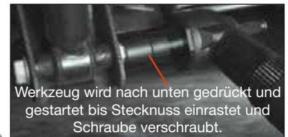
Haltestecknuss passt auf die Schraube und verhindert ihre Rotation.
