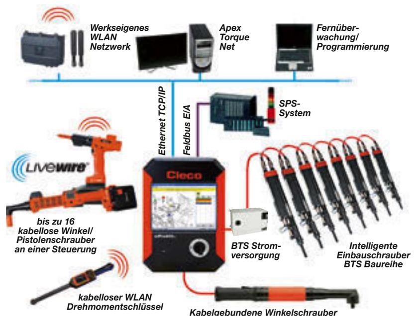
Eine Schraubersteuerung kann bis zu 16 kombinierbare Schraubwerkzeuge erfassen und prozessorientiert kontrollieren.
