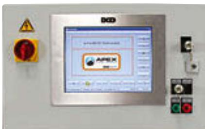
Auch an den Schraubersteuerungen mPro400S/ mPro400SE/ mPro400SG/ CPM3/ CPM6/ CPM9 und an anderen DGD/ Cleco Steuerungen können die LiveWire Akku Werkzeuge betrieben werden. Fragen Sie uns - wir bieten Ihnen bestmögliche und effektive Lösungen für Ihre Schraubprozesse.
