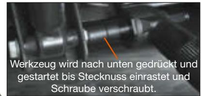
Werkzeug wird nach unten gedrückt und gestartet bis Stecknuss einrastet und Schraube verschraubt.
