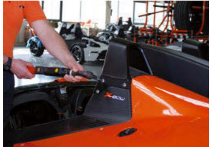
Cleco LiveWire Schraubwerkzeuge im Einsatz beim österreichischen Sportwagenhersteller KTM in Graz. LiveWire Winkel und Pistolenschrauber zusammen mit einem kabellosen elektronischen Drehmomentschlüssel an einer gemeinsamen Schraubersteuerung. Kabellose Produktivität für alle sicherheitskritischen Schraubstellen am Premium Sportwagen X-Bow.
