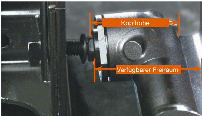
Flush Stecknuss Werkzeuge haben viel Freiraum, um in Anwendungen mit wenig Freiraum zu passen. Elektrische Flush Stecknuss Werkzeuge verschrauben mit einer viel höheren Präzision als Werkzeuge mit einem Flachabtrieb-Aufsatz.
