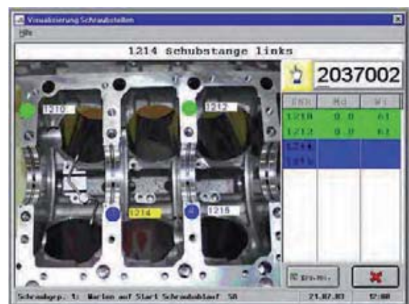
Visualisierung mit Hintergrundbild am m-Pro-400S/SE Bildschirm Visualization with background image on m-Pro-400S/SE screen
